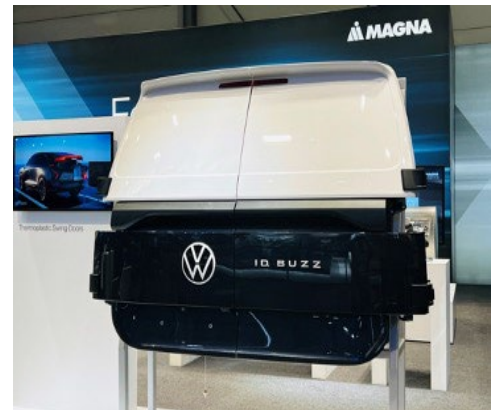
Die von Magna entwickelten thermoplastischen Heckflügeltüren kommen mit dem Volkswagen ID Buzz auf den Markt
